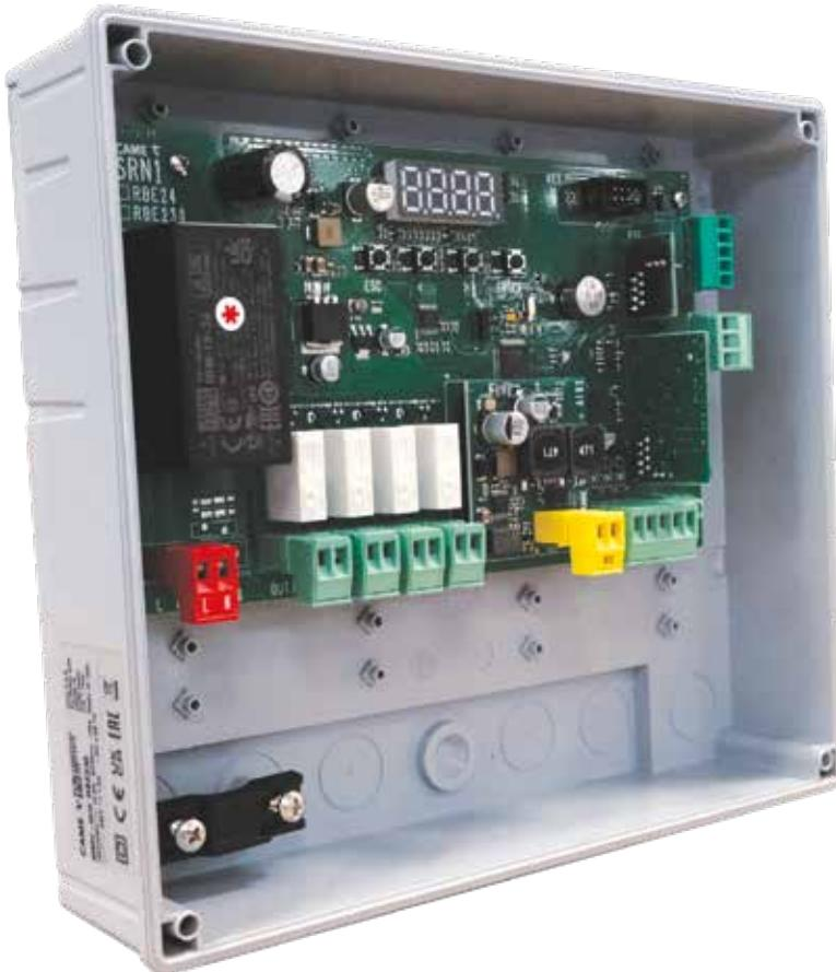
**RBE Plus** es el nuevo cuadro de mando para el control de accesos, específico para utilizarse con transmisores y todos los accesorios CXN BUS de CAME.
